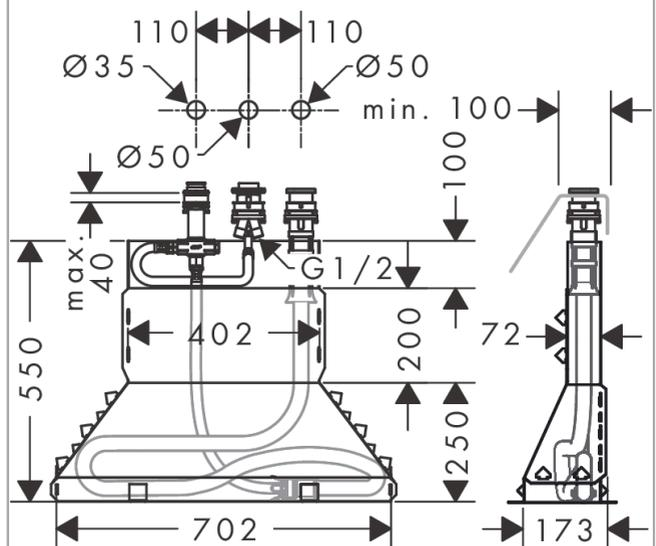
**Скрытая часть однорычажного смесителя на край ванны на 3 отверстия**
