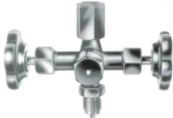
Вентиль с изолированным тестовым присоединением по DIN 16 272, муфта/цапфа настраиваемая гайка/внешн.резьба G 1/2, с тестовым присоединением M 20 x 1.5, PN 400
