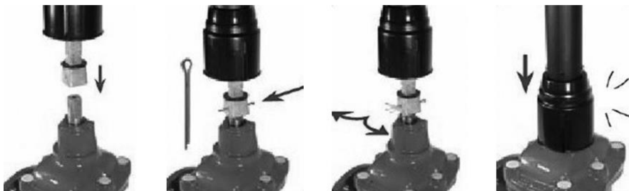
Рис. 4 Порядок установки телескопического штока на задвижку.
