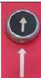
После того, как тележка дежи правильно вставлена на вилы подъемника, нажатием данной кнопки можно поднять дежу в положение разгрузки для выгрузки теста.
