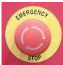
Все операции поднятия могут быть остановлены нажатием на кнопку экстренной аварийной остановки (позиция 3). Для продолжения выполнения движения вверх/вниз при поднятии необходимо сначала вернуть в начальное положение кнопку экстренной аварийной остановки, поворачивая ее по направлению часовой стрелки, и только после этого нажимать соответствующую команду кнопки.
