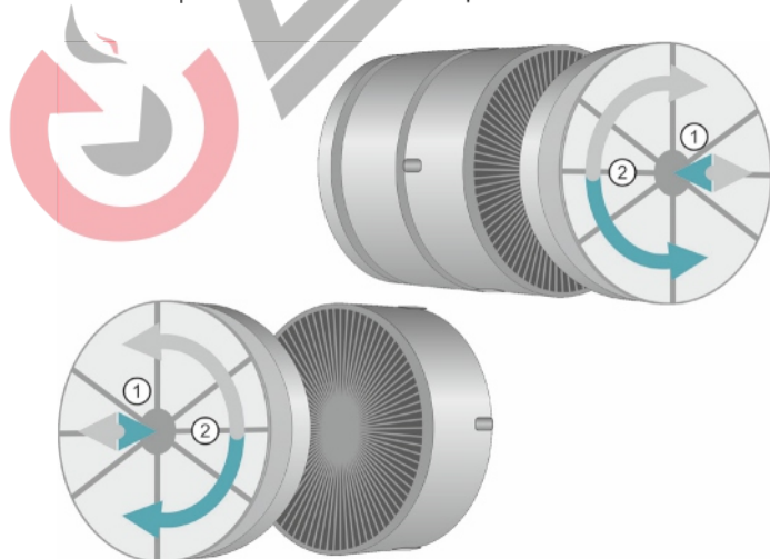
Рис. 14 Установка угольного фильтра
