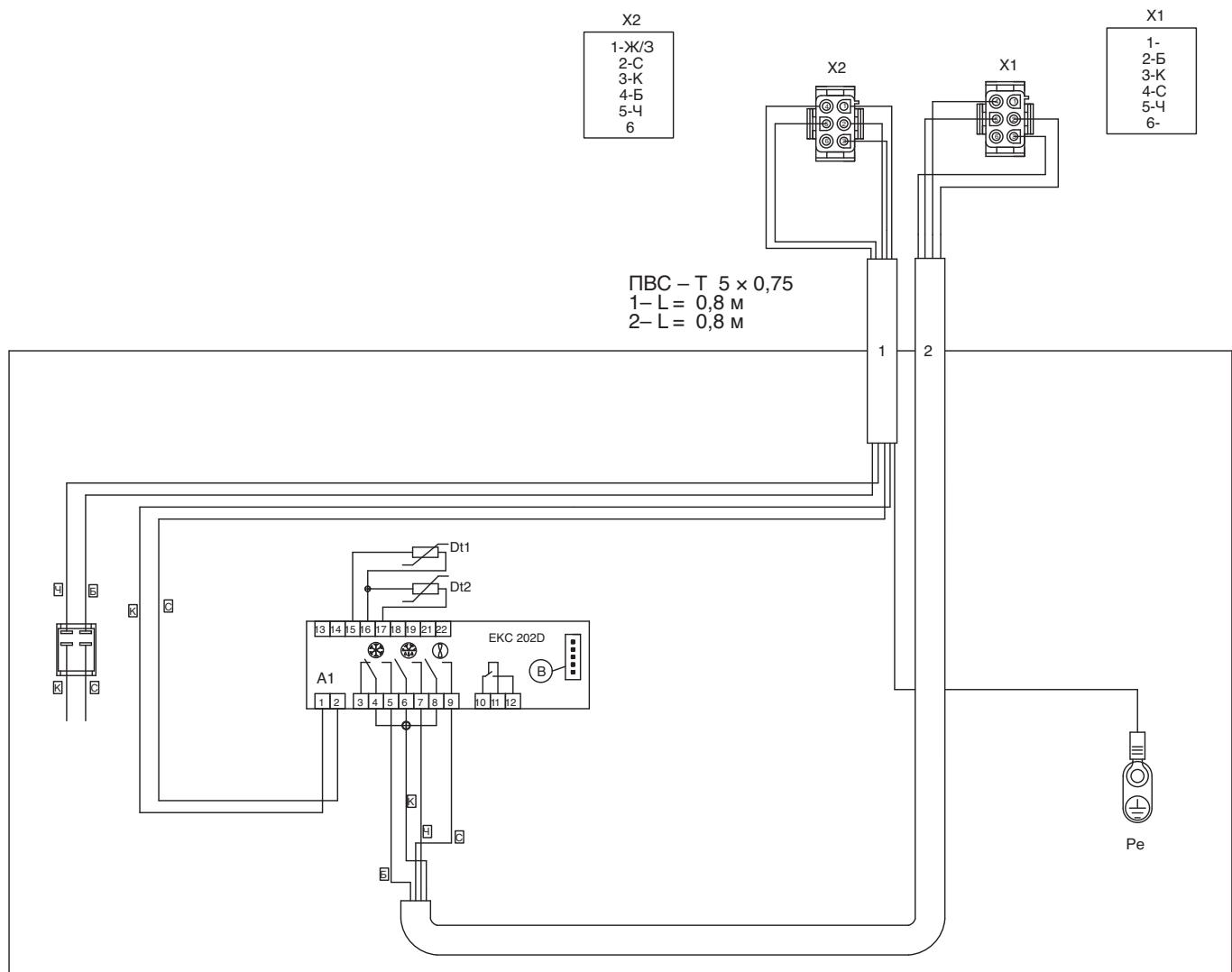
Схема электрическая монтажная холодильной витрины
