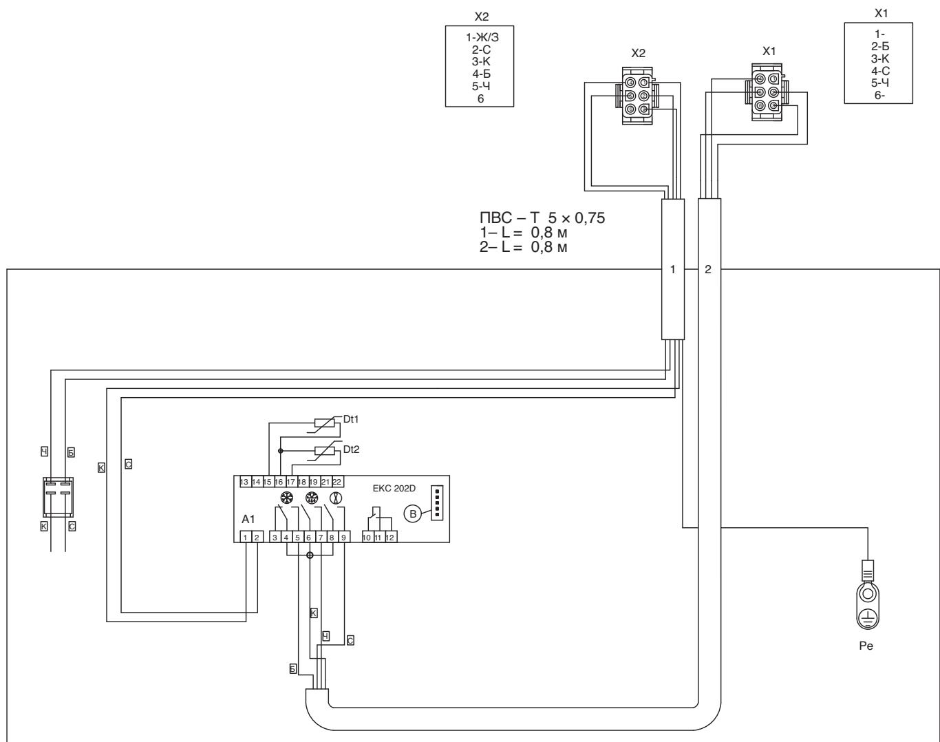
Схема электрическая монтажная холодильной витрины
