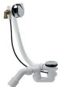
Viega Multiplex Trio Комплект механический Слив-перелив с функцией наполнения через перелив (наполнение 25 л / мин. – 3 бар, слив 51 л / мин.)
