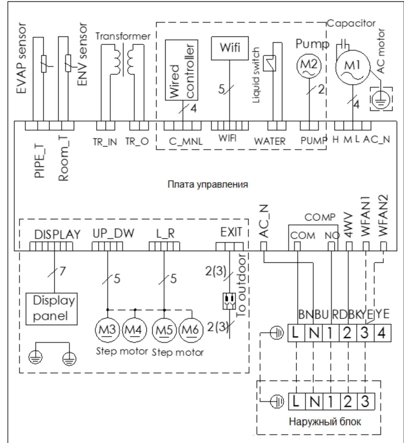
○ Схема электрическая внутренних блоков моделей IDX-12H, IDX-18H
