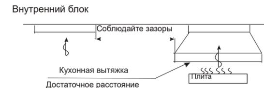
Кухня должна быть оснащена вытяжной вентиляцией такой мощности, чтобы масло, пар, мука и частицы продуктов выводились из помещения и не оседали на узлах кондиционера. Внутренний блок должен располагаться достаточно далеко от кулинарного оборудования и мест приготовления пищи; таким образом загрязняющие вещества не будут попадать внутрь блока.
