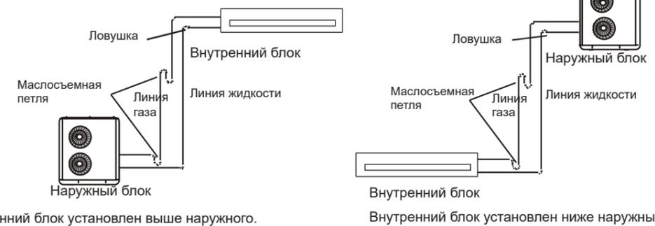
Примечание. Схема приводится для объяснения принципа работы. Фактическая система будет отличаться от иллюстрации. При создании маслосъемной петли радиус изгиба должен в 1,5-2 раза превышать диаметр трубной линии.
