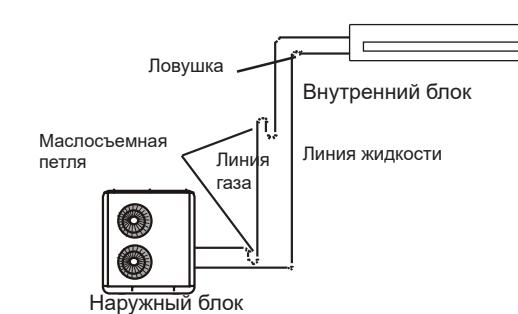
Внутренний блок установлен выше наружного.
