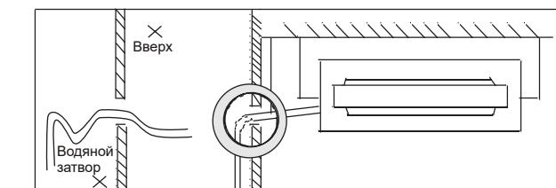
Примечание. Линия отвода конденсата должна быть обернута теплоизоляцией во избежание конденсации или протечек.
