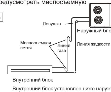
Внутренний блок установлен ниже наружных
