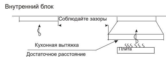
Кухня должна быть оснащена вытяжной вентиляцией такой мощности, чтобы масло, пар, мука и частицы продуктов выводились из помещения и не оседали на узлах кондиционера. Внутренний блок должен располагаться достаточно далеко от кулинарного оборудования и мест приготовления пищи; таким образом загрязняющие вещества не будут попадать внутрь блока.
