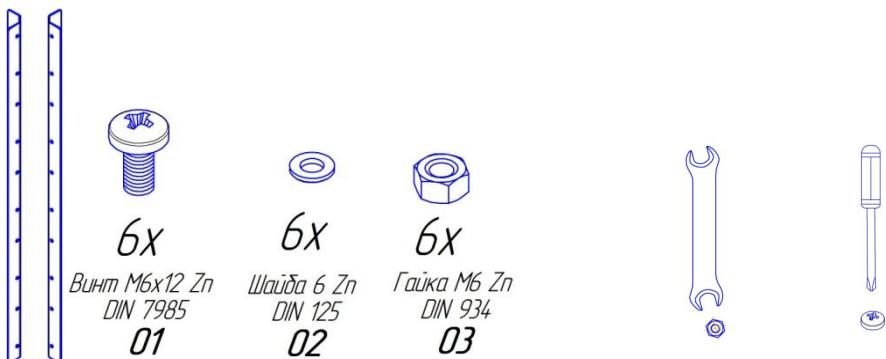
Кронштейны для полки TOOLEX (к-т) необходимы для установки Полки TOOLEX 300 XS (артикул: 323-3000-01). Комплект рассчитан на установку 5 полок максимально. Для установки кронштейнов необходимо снять внешние стенки Тележки TOOLEX XS (артикул: 321-0001-01) (смотри пункт 2 на стр.4). После установки кронштейнов стенки необходимо поставить обратно. Кронштейны можно устанавливать с двух сторон Тележки TOOLEX XS (артикул: 321-0001-01)/
