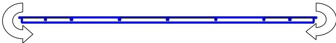
Установленные фиксаторы образуют внутри ящика раму. Перегородки устанавливаются в пазы этой рамы, образуя ячейки.
