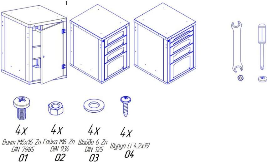
Комплект крепежа монтажный М6 необходим для крепления Тумб между собой (см. рис. ниже), шурупы Li – для крепления Столешницы W WOKER. Для соединения Тумб между собой нужно открыть дверцу Тумбы WOKER 1, а другой Тумбы дверцу, если Тумба имеет ящики, то их необходимо извлечь. Для этого их необходимо выдвинуть и нажать на фиксаторы, как показано на рис. (см. ниже).
