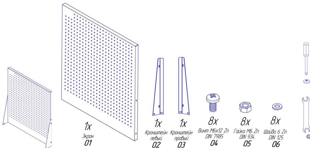
Экран на тумбу WOKER устанавливается на Лоток WOKER (артикул: **410-0001-02**). Установка Лотка WOKER изображена на стр.6. В комплект поставки дополнительные комплектующие (Держатель ключей, отверток, Полка 550/160 и др.) не входят (приобретаются отдельно). Их установка будет показана ниже.
