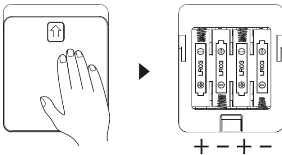
Переверните весы; батарейный отсек находится на задней панели весов.
