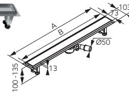
**Душевой лоток линейный для укладки керамической плитки**
