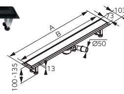
**Душевой лоток линейный для укладки керамической плитки****НОВИНКА**
