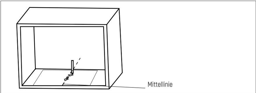
3. Entfernen Sie die untere Modulschablone und befestigen Sie die Montagehalterung mit Schraube A.
