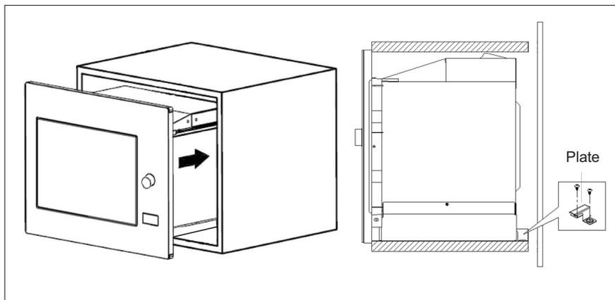
5. Откройте дверь и прикрепите печь винтом «В» к кухонному модулю, используя соответствующее отверстие. После чего закройте это отверстие пластиковой заглушкой из отделочного комплекта.
