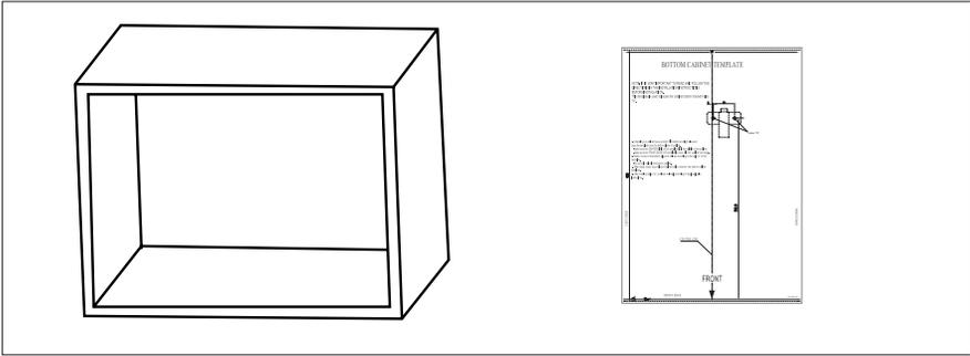
2. Сделайте отметки на нижней плоскости кухонного модуля в соответствии с отметками "а" на шаблоне.
