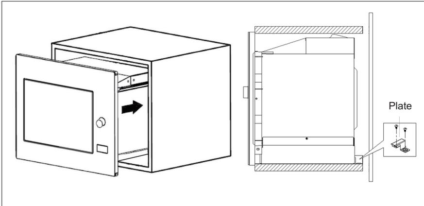
5. Öffnen Sie die Tür und befestigen Sie den Backofen mit der Schraube " B " am Küchenmodul mit der entsprechenden Bohrung. Verschließen Sie dieses Loch dann mit einem Plastikstopfen aus dem Finishing-Kit.
