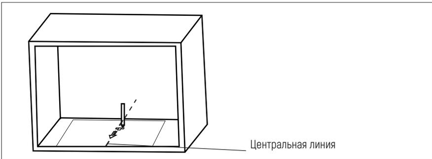
3. Снимите шаблон нижнего модуля и закрепите установочный кронштейн винтом А.
