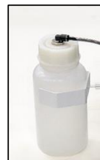
Obr. 16: Kontrola nádoby na zber kondenzátu
