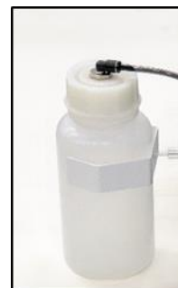
Рис. 16: Проверка резервуара для сбора конденсата
