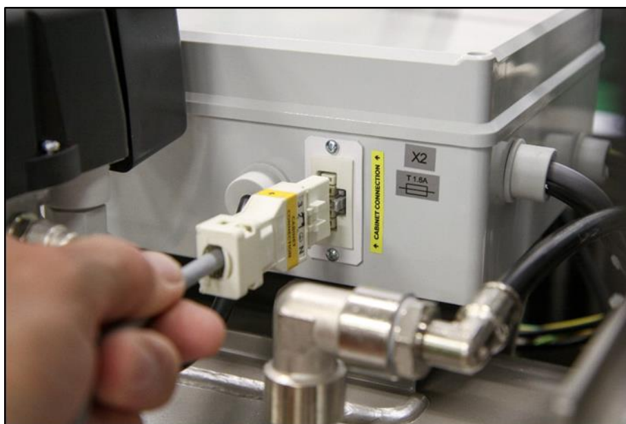
Obr. 13: Zapojení skříňky ke kompresoru
