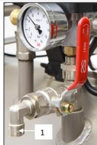
Рис. 8: Подключение к выпускному воздуховоду сжатого воздуха
