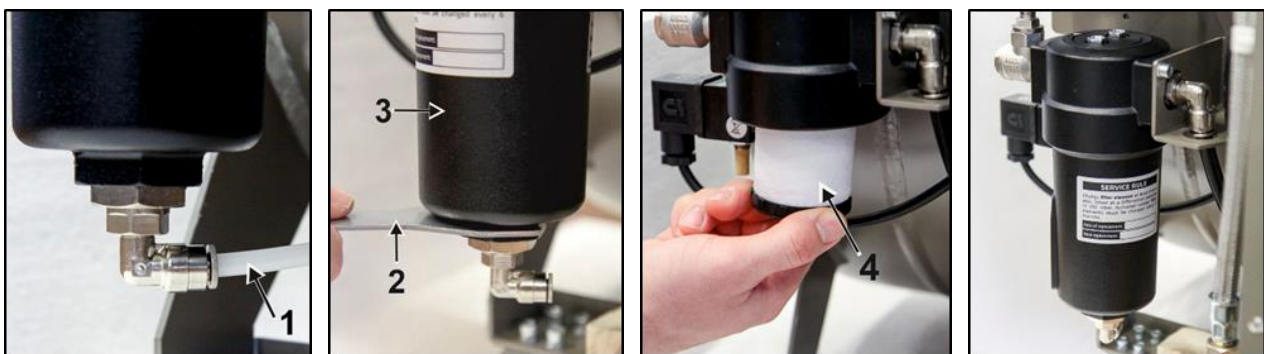
Fig. 19: Remplacement de l'élément filtrant
