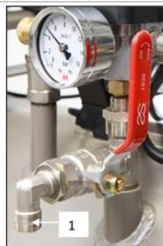
Fig. 8: Raccordement à la prise d'air comprimé
