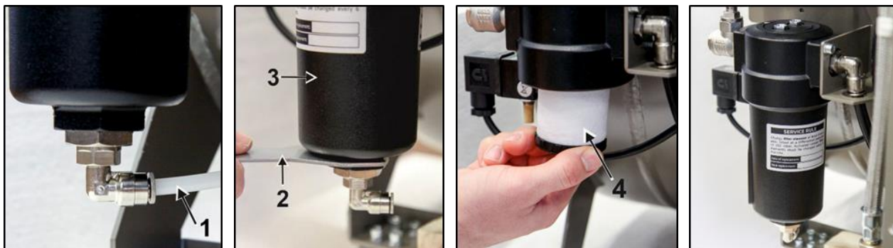
Obr. 19: Výmena filtračnej vložky vo filtri
