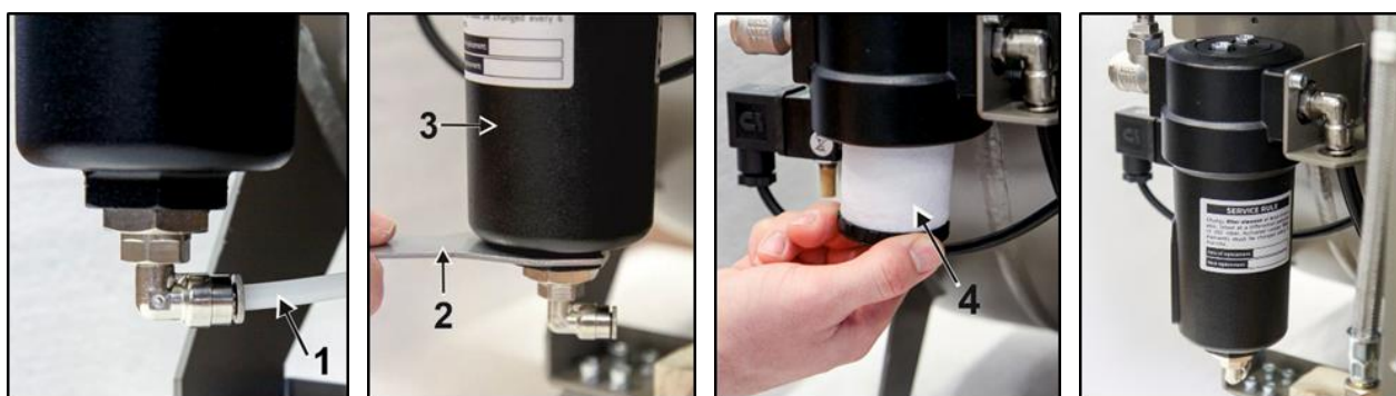
Рис. 19: Замена фильтрующего элемента
