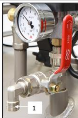
Obr. 8: Pripojenie k výstupu stlačeného vzduchu
