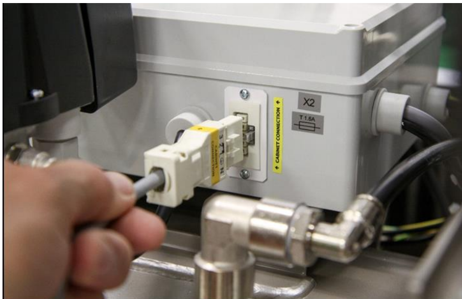
Obr. 13: Zapojenie skrinky ku kompresoru
