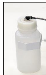
Rys. 16: Sprawdź poziom kondensatu w naczyniu
