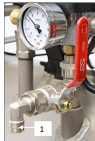
Abb. 8: Anschluss an den Druckluftausgang
