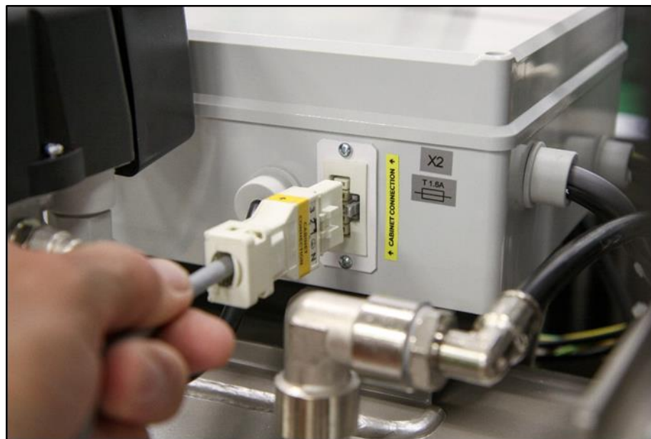
Abb. 13: Anschließen des Gehäuses an den Kompressor
