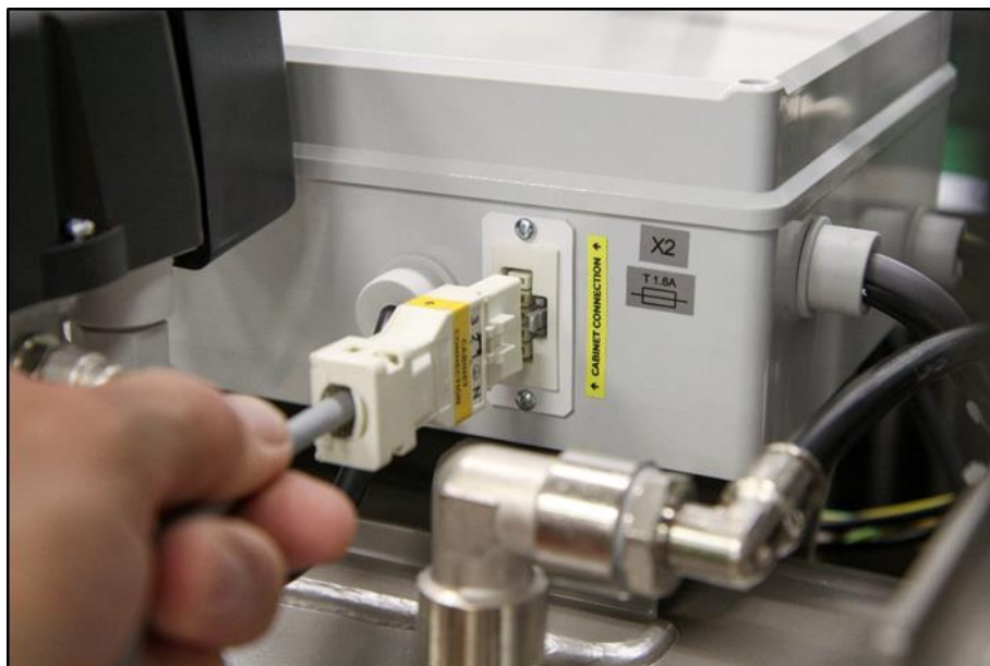
Rys. 13: Podłączanie obudowy do sprężarki
