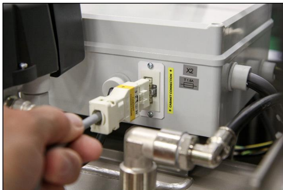
Рис. 13: Подключение шкафа к компрессору
