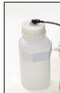
Abb. 16: Überprüfen des Kondensatauffangbehälters
