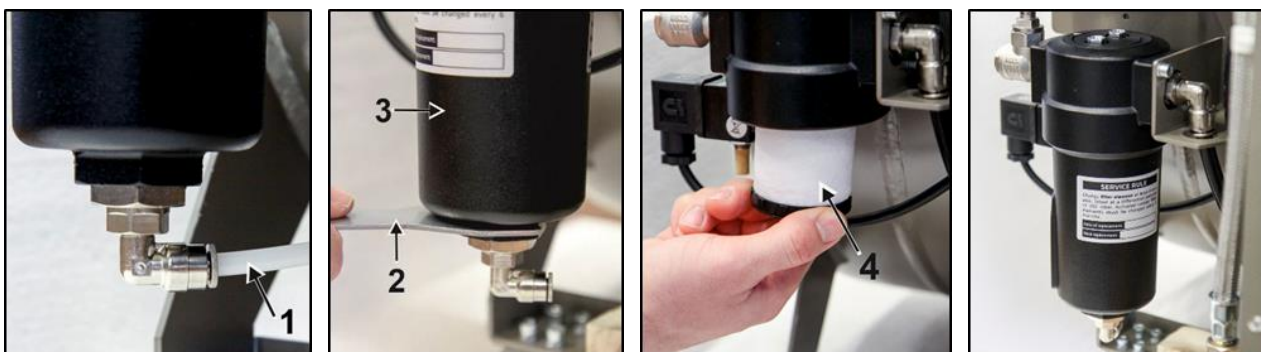
Abb. 19: Austausch des Filterelements
