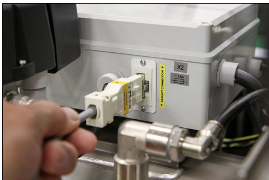
Fig. 13: Raccordement de l'armoire au compresseur
