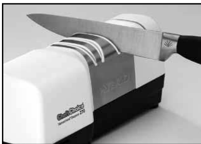
Рисунок 4. Лезвие в левом пазу Устройства 2. Чередуйте проходы в левом и правом пазах.
