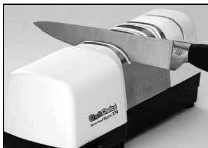
Рисунок 1. Лезвие в левом пазу Устройства 1. Чередуйте проходы в левом и правом пазах.
