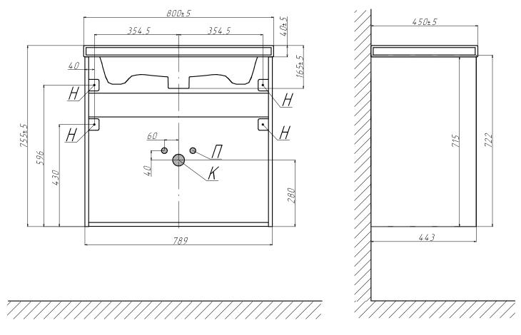
Н - Крепления навесок; П - Подводка воды; К - Вывод канализации
