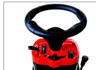
Включение электромагнитной муфты производится бесшумно нажатием кнопки, удобно расположенной на приборной панели
