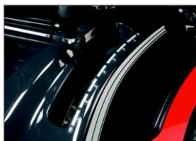
Удобно расположенный рычаг регулировки высоты среза с градуированной шкалой позволяет мгновенно определять желаемый уровень высоты стрижки травы
