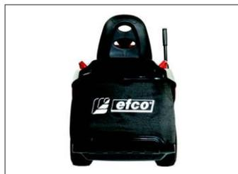
С помощью удобного расположения телескопической ручки опустошения травосборника можно легко дотянуться до нее с места оператора, чтобы выполнить опрокидывание заполненного травосборника
