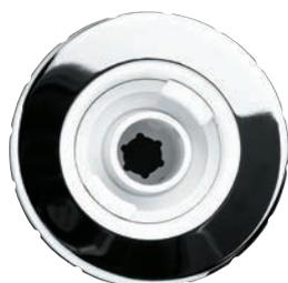
Гидрофорсунки подают смесь воды и воздуха. В результате подачи смеси происходит сильное массажное воздействие. Гидрофорсунки Махи имеют хромированный фасад диаметром 90 мм. Силу воздействия водной струи можно настроить вращением внутренней части форсунки. Направление водной струи настраивается поворотом внутренней части форсунки. Эти форсунки используются в ваннах Thermae для массажа спины и бёдер.
