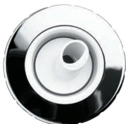
Гидрофорсунки подают смесь воды и воздуха. В результате подачи смеси происходит сильное массажное воздействие. Гидрофорсунки Махи ротационные имеют хромированный фасад диаметром 90 мм. Силу воздействия водной струи можно настроить вращением внутренней части форсунки. В ротационной форсунке сила потока воды создает дополнительное вращение сопла, что увеличивает массажный эффект. Эти форсунки используются в ваннах Thermae.
