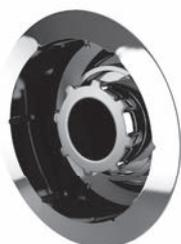
Гидрофорсунки подают смесь воды и воздуха. В результате подачи смеси происходит сильное массажное воздействие. Гидрофорсунки Lux имеют хромированный фасад диаметром 70 мм. Эти гидрофорсунки используются для массажа бедер в системах Joy и Bliss. Силу воздействия водной струи можно настроить вращением внутренней части форсунки. Заворачиванием форсунки силу воздействия уменьшают. Направление водной струи настраивается поворотом внутренней части форсунки.
