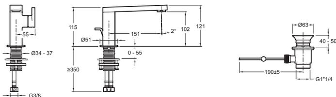
Спецификация продукта: Смеситель для умывальника. E73167. Коллекция: COMPOSED. ВЕС: 2,5 кг. ТИП УСТАНОВКИ: 1 отверстие. ТИП: Однорычажный. РАСХОД ВОДЫ: 5 л/мин. ВЫСОТА ПОД ИЗЛИВОМ: 115 мм. РАССТОЯНИЕ МЕЖДУ ЦЕНТРОМ ИЗЛИВА И ЦЕНТРАЛЬНОЙ ОСЬЮ КОРПУСА: 151 мм. ПОДКЛЮЧЕНИЕ: С гибкой подводкой. МЕХАНИЗМ: Керамический картридж. СЛИВ: 0. ОДНОРЫЧАЖНЫЙ СМЕСИТЕЛЬ: 0. УСТАНОВКА: 1 отверстие. ГАРАНТИЯ НА ОТДЕЛКУ: 10 лет на покрытие "Хром" и 25 лет на покрытие "Титан".
