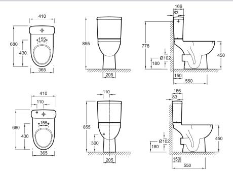
Спецификация продукта: Высокий унитаз с горизонтальным выпуском. 4966СК. Коллекция: ОDEON UP. РАЗМЕРЫ (СМ): 68 х 36,50 см. ВЕС: 24,2 кг. РАСХОД ВОДЫ: 2,6/4 л и 3/6 л. ВЫСОТА: Высокие/ПРОФ. ОБОД: 45 см, для людей с ограниченными возможностями. ПРОДУКТ В КОМПЛЕКТЕ: (бачок и крышка-сиденье заказываются отдельно). УПАКОВКА: Единая упаковка.
