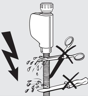
⚠ Заливной шланг **нельзя** укорачивать или повреждать, так как в нём имеются детали, находящиеся под напряжением (см. рисунок).
