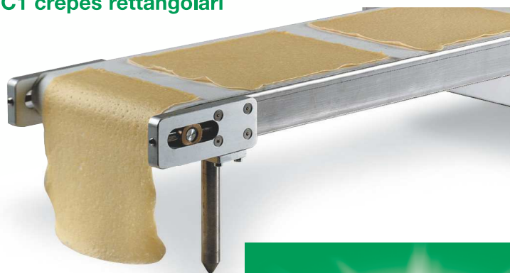
1 Particolare rullo riscaldatore C1 crêpes rettangolari
