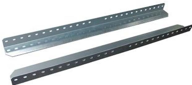
Уголки опорные (направляющие) для напольных шкафов МиК служат для размещения различного тяжелого оборудования (наиболее часто – для корпусов серверов). Фиксируются в горизонтальном положении на передние и задние направляющие 19" стандарта в напольных телекоммуникационных и серверных шкафах, а также в двухрамных стойках с помощью крепежного комплекта М6: винт, гайка, шайба (в комплект поставки не входит).
