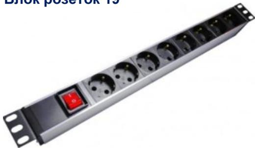
**Блок розеток 19", выключатель, 220В, 16А, 1U, 8 розеток (Schuko), алюм. корпус, серебр., без шнура** предназначен для установки в 19" конструктивы (телекоммуникационные и серверные шкафы, телекоммуникационные стойки, антивандальные шкафы) и крепится с помощью крепежного комплекта М6 (винт, гайка, шайба).
