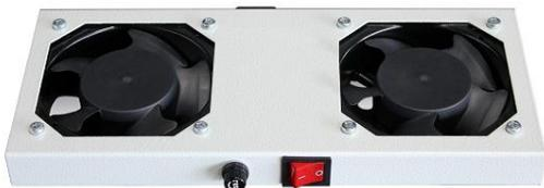
Модули вентиляторные Мик предназначены для обеспечения вентиляции установленного оборудования в телекоммуникационных настенных разборных шкафах Мик. Устанавливается в специально подготовленные отверстия в верхней части шкафа с помощью 8-ми винтов М5х12 и стопорных шайб, входящих в комплект поставки.
