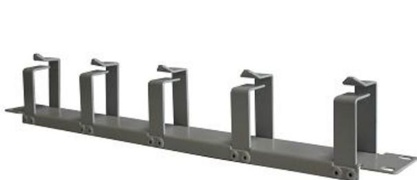
**Органайзер 1U 19" горизонт. универсальный с 5 кольцами 44x60mm (07.007.002/01)** предназначен для оптимизации размещения кабеля внутри телекоммуникационных шкафов, а также при размещении в открытых телекоммуникационных стойках. Соответствует стандарту 19" и крепится к направляющим шкафа или стойки с помощью 4-х крепежных комплектов М6 (в комплект поставки не входят).
