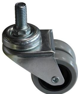
**105.001.007 Комплект роликов для шкафа напольного МИК ЕСО** (4 шт.) предназначен для установки в нижнюю часть шкафа, в качестве альтернативы стандартным ножкам. Установка роликов позволяет осуществлять легкое передвижение телекоммуникационного шкафа в случае необходимости. Ролики имеют винтовое крепление М12. Предельная допустимая нагрузка на шкаф, который установлен на ролики – 300 кг.
