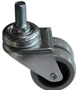
**105.001.007 Комплект роликов для шкафа напольного МиК ЕСО** (4 шт.) предназначен для установки в нижнюю часть шкафа, в качестве альтернативы стандартным ножкам. Установка роликов позволяет осуществлять легкое передвижение телекоммуникационного шкафа в случае необходимости. Ролики имеют винтовое крепление M12. Предельная допустимая нагрузка на шкаф, который установлен на ролики – 300 кг.
