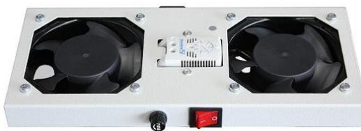
**Модули вентиляторные МиК** предназначены для обеспечения вентиляции установленного оборудования в телекоммуникационных настенных разборных шкафах МиК. Устанавливается в специально подготовленные отверстия в верхней части шкафа с помощью 8-ми винтов M5x12 и стопорных шайб, входящих в комплект поставки.
