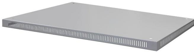
Крыша к напольным 19" телекоммуникационным шкафам серии ECO предназначена для дополнительной защиты верхней части шкафа от пыли, а также предоставляет возможность скрыть отдельные элементы кабельных систем при верхнем размещении. Крыша рекомендуется к использованию вместе с потолочными вентиляторными панелями - вертикальная перфорация по боковым стенкам крыши обеспечивает необходимый приток воздуха для охлаждения оборудования внутри шкафа.
